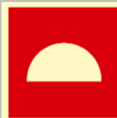
Kurek główny instalacji gazowej
