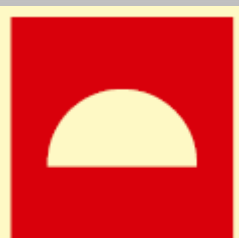
Przeciwpózarowe stanowisko czerpania wody
