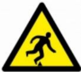
Ostrzeżenie przed niebezpieczeństwem potknięcia się
