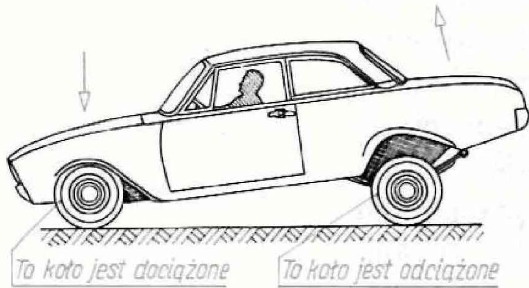
Rys. 3.86 Poglądowe wyjaśnienie dociążenia kół przednich podczas hamowania [3]
